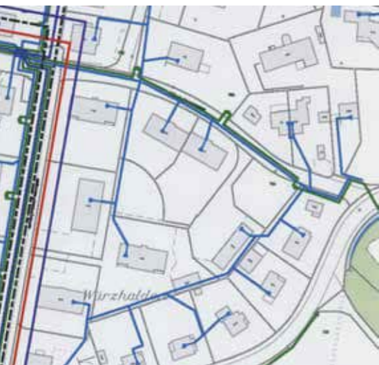
Gemufftes Netz (alle Häuser hängen an der selben Leitung)
