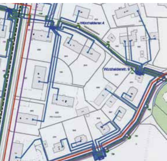
Sternförmiges Netz (jedes Haus wird einzeln an einer KVK angeschlossen)
